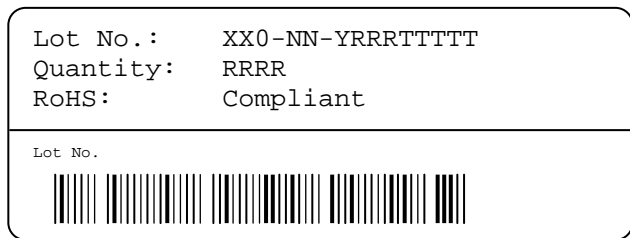
图 19: 胶盘上的第一个标签: XX=传感器型号 (11 即 SHT11), NN=芯片版本 (04表示V4), Y=年份的数字标识, RRR=胶盘上的传感器数量除以10 (通常为200或2000), TTTTT=追踪代码。
