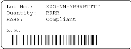
图12 卷轴上的标签: XX = 传感器型号 (21 for SHT21), O = 输出方式 (D = Digital, P = PWM, S = SDM), NN = 芯片版本, Y = 年的最后一位, RRR = 卷轴上的传感器数量除以10。TTTT = 追踪代码。
