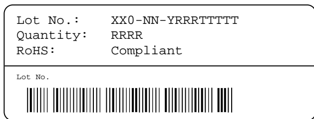
图 14: 胶盘上的第一个标签: XX=传感器型号 (71 即 SHT71), NN=芯片版本 (04 表示 V4), Y=年份的数字标识, RRR=胶盘上的传感器数量除以 10 (通常为 200 或 2000), TTTT=追踪代码。
