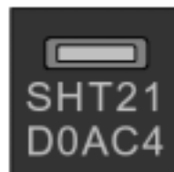
图 14 传感器上的激光标识. 具体含义详见上文卷轴上面也贴有标签, 如图 15 和图 16 所示, 并提供了其他的跟踪信息。
