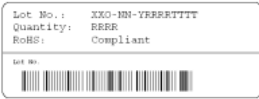
图15 卷轴上的标签：XX = 传感器型号 (21 for SHT21), O = 输出方式 (D = Digital, P = PWM, S = SDM), MN = 芯片版本, Y = 年的最后一位, RRRR = 卷轴上的传感器数量。TTTT = 追踪代码。
